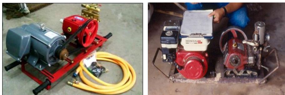
ภาพที่ 12 เครื่องยนต์พ่นสารแบบใช้แรงดันน้ำสูง ประเภทสองคนหามและติดตั้งล้อเข็น
