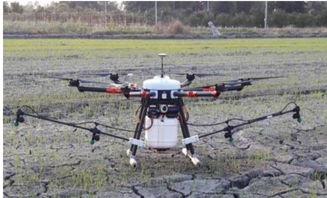
ภาพที่ 16 โดรนพ่นสารป้องกันกำจัดศัตรูพืช
