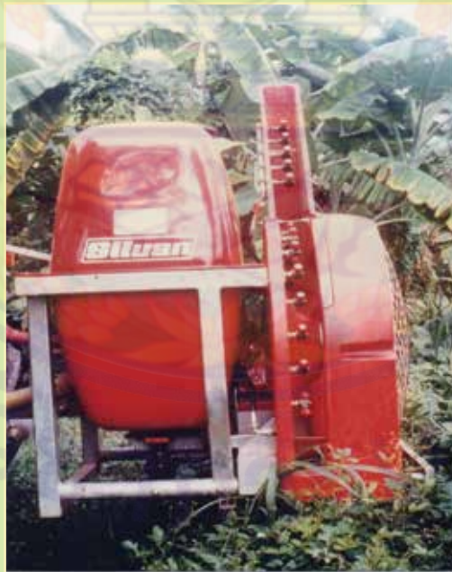
การติดตั้งหัวฉีดบนเครื่องแอร์บลาสท์
