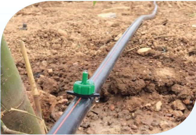
แสดงการให้น้ำหยดแบบติดบนท่อ
